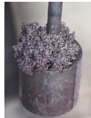
図 5 Cd 陽極電解法で電解回収したウラン
